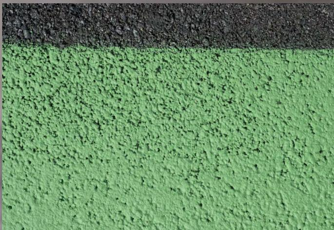
TOP COLOR ASF può essere utilizzato per la segnalazione ed evidenziazione di passaggi pedonali, marciapiedi, percorsi ciclabili, corsie e qualsiasi area di intersezione stradale; il rivestimento delle pavimentazioni di aeroporti, distributori di carburante, aree di servizio e per le applicazioni dove sia richiesta resistenza agli oli e agli idrocarburi; la realizzazione di parcheggi, aree giochi e discipline sportive.
